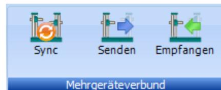
Die Funktion „Mehrgeräteverbund synchronisieren“ stellt sicher, dass ein Messprogramm erst dann weiter ausgeführt wird, wenn auch auf den anderen Messgeräten im Verbund der Programmsatz mit der entsprechenden Identifikation ausgeführt ist.
