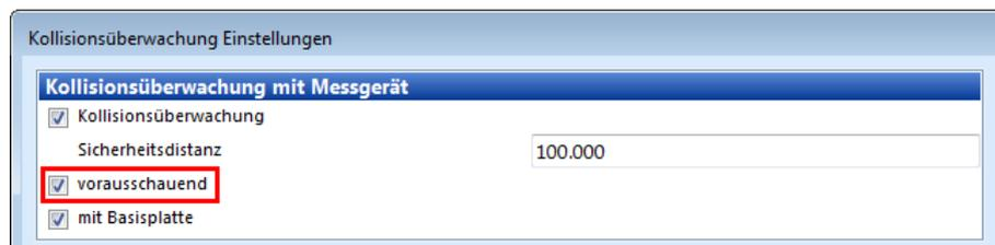
Die vorausschauende Kollisionsvermeidung basiert auf mitlaufenden Sicherheitszonen, welche automatisch um die Tasterkonfiguration und die Messgerätekomponten berechnet werden. Sie wirkt sowohl im Mehrgeräteverbund (mehrere Metrosoft QUARTIS steuern mehrere Messgeräte über QUARTIS- oder DMIS-Programme) wie auch im Mehrgerätebetrieb (eine Metrosoft QUARTIS steuert mehrere Messgeräte über DMIS-Programme).
