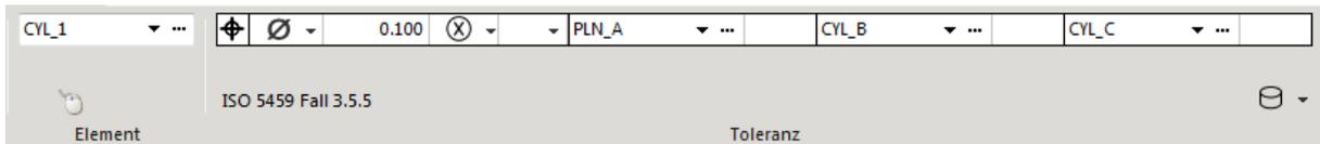
Sie spezifizieren die Toleranzzone, den Toleranzwert, die Berechnungsart sowie das Bezugssystem in der Art und Weise, wie Sie es von der Konstruktionszeichnung her kennen.
