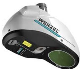
Mit dem WENZEL Linienscanner WM | LS wird ein weiterer optischer Sensor unterstützt. Sie haben damit grundsätzlich dieselben Möglichkeiten wie mit dem WENZEL Shapetracer 2.
