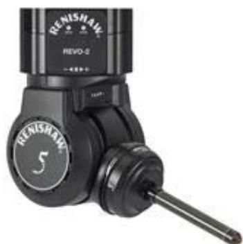
Der Renishaw REVO RUP1 Ultraschall-Messtaster ermöglicht die einseitige Messung von Werkstückdicken und bietet damit die Möglichkeit, Merkmale zu messen, die bisher mit taktilen Systemen nicht zugänglich waren.
